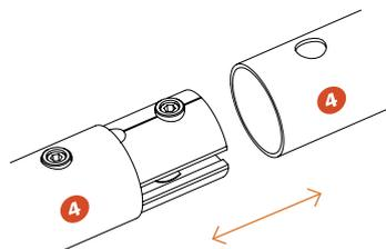
Verrouillage des sections par clé Allen
